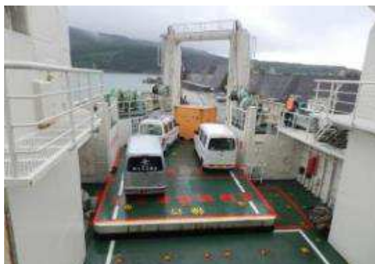
上下するリフトにより車両搬出
