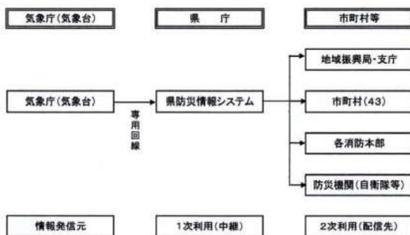
図 気象情報自動伝達システムによる地震情報の伝達系統（鹿児島県地域防災計画より）
