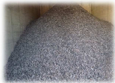
RPF固形化燃料 (紙類・プラスチック類を加工したもの)
