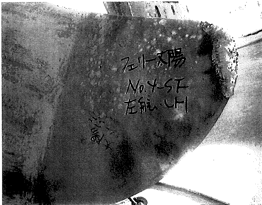
左回転 No.4翼 圧力面側
