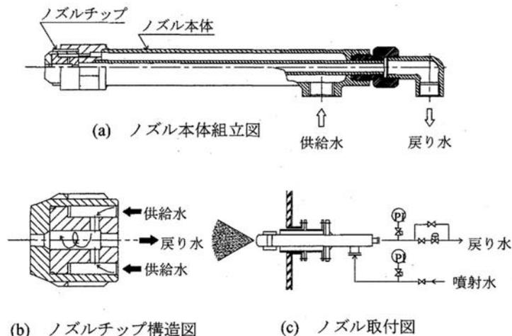
(a) ノズル本体組立図 (b) ノズルチップ構造図 (c) ノズル取付図
