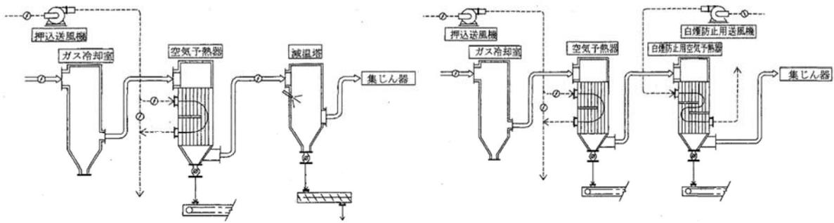
(a) ガス冷却室、空気予熱器、減温塔方式
