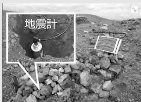
▲ 野池山3観測点の様子と交換した地震計感部
