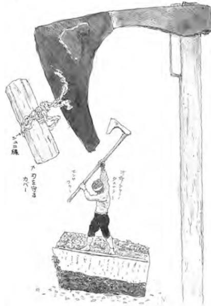
ハツリ斧(イチヨウバ)は、切り倒した丸太を、角材に加工する際に使われていた民具です。刃の形が、イチヨウの葉に似ていることから、イチヨウバとも呼ばれていました。絵のように丸太の上に立ち、何度も何度も振り降ろし、少しずつ削っていきます。このようにして荒取りした材は、木馬などで山から運び出しました。
